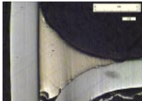
Coupe métallographique de joint soudo-brasé laser.
