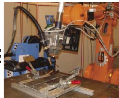
Mise en oeuvre du soudage hybride YAG+MIG/MAG
