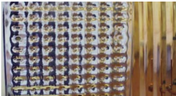
Plaque d'échangeur thermique soudée au laser.
