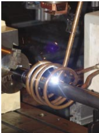
Soudage avec préchauffage par induction.
