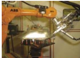
Mise en oeuvre du soudo-brasage laser.
