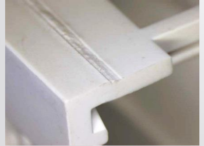
Assemblage en bord à bord d'un boîtier électronique en polycarbonate avec des oxydes de titane
