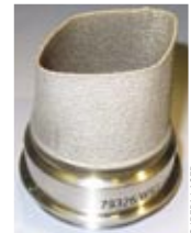
Ajout d'une tubulure sur une bride existante.
