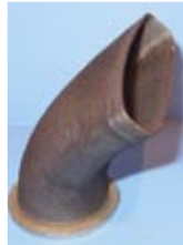
Prototype à l'échelle 1/3 d'un conduit d'air Dassault
