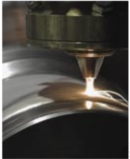
Rechargement par injection coaxiale de poudre avec laser CO 2
