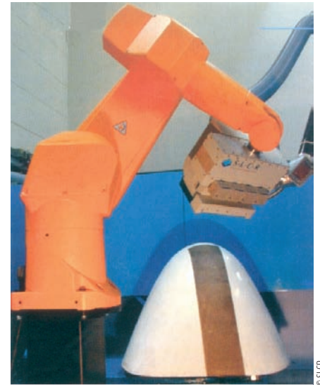
FIGURE 12 : Élimination de la peinture sur un radom.
