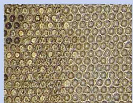
FIGURE 9 : Élimination de la couche de téflon par laser.
