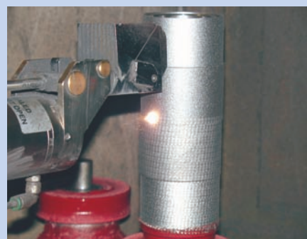
FIGURE 15 : Préparation de surface avant surmoulage.
